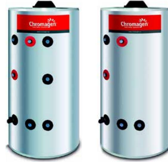
Interacumulador de acero con tratamiento vitrificado en esmalte idóneo para instalaciones de ACS. Temperatura máxima de trabajo 95°C. Presión máxima de trabajo en ACS 8 bar y 3 bar en Doble envolvente ú 8 bar en Serpentin.
